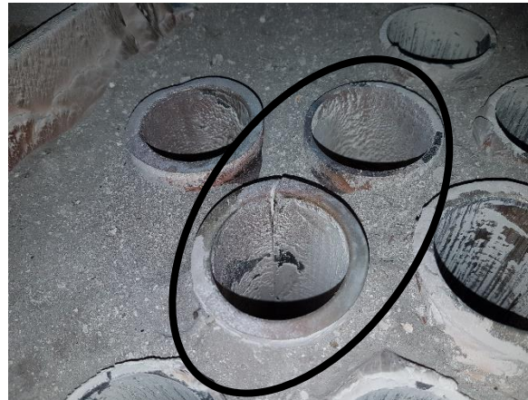
Foto visende forskel på belægninger med/uden foring
